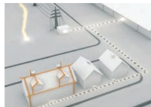
Blitzeinschläge neben die Versorgungsleitung und Schalthandlungen
