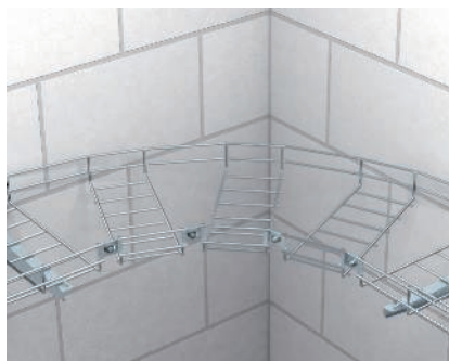
Herstellung eines Gitterinnenbogens - rund Durch Ausschneiden jeder zweiten Masche konnen Gitterinnenbogen mit groerem Radius hergestellt werden. Die Fixierung erfolgt mit Eckverbindern Typ GEV 36.
