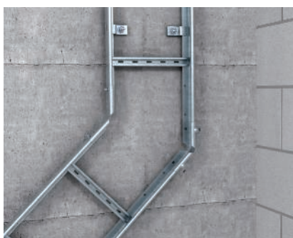
Winkelverbinding von Kabelleitern Erstellen flexibler Steigeleiterwinkel mit Winkelverbinder Typ LWWG.
