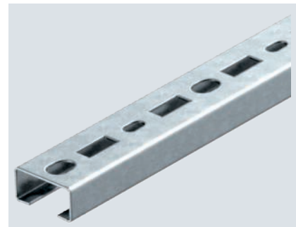
Mittlere C-Profilschiene zur Kabelverlegung, in Verbindung mit Bügelschellen mit Hammerkopf-Fuß. Auch verwendbar als Abhängekonstruktion für Kabeltragsysteme.
