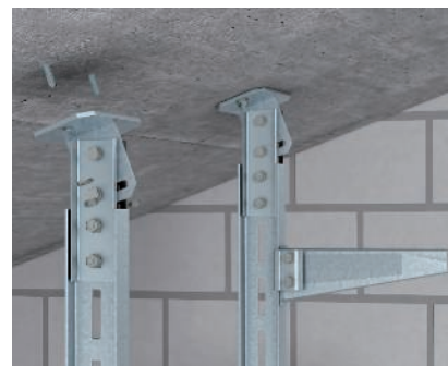
Kopfplatte variabel (90° gedreht) Montage der variablen, um 90° gedrehten Kopfplatte Typ KI 8 VLK an schräger Betondecke mit Bolzenankern.
