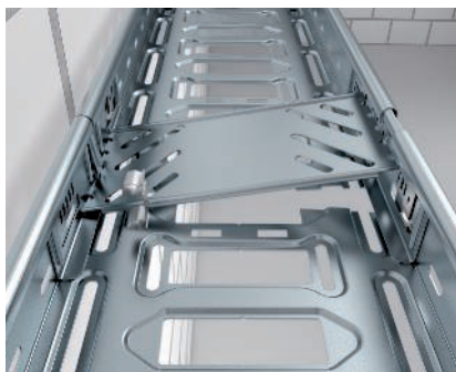
Montage Längsverbinder-Set Magic KTSMV Die zugehörige Stoßstellenleiste in die Führung einsetzen, nach unten drücken und einfach einrasten. Zur Verstärkung der Verbindung wird ab der Breite 400 mm ein Verschrauben der Stoßstellenleiste empfohlen.
