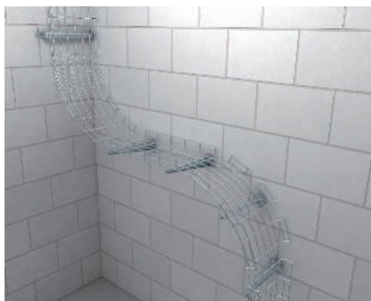
Steigende und fallende Bogen Durch Einschnitte in jede zweite Masche der Gitterrinnenkante und entsprechendes Biegen lassen sich steigende und fallende Vertikalbogen herstellen.
