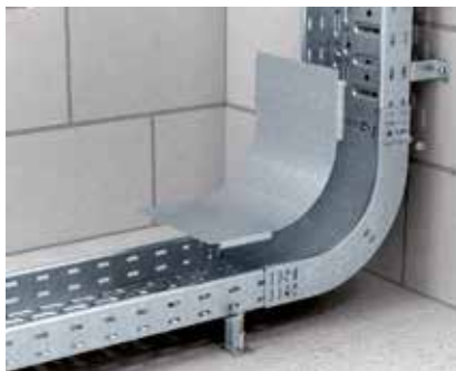
Bogen 90° (steigend/fallend) Der Bogen 90° vertikal wird über den Holm der Kabelrinne geschoben und mit Flachrundschrauben FRSB M6x12 mm verschraubt. Der Deckel wird lose aufgelegt und mit den der ankommenden Kabelrinnendeckeln befestigt. Zur zusätzlichen Befestigung kann die Deckelklammer DKU eingesetzt werden.
