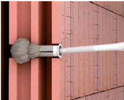
Injektionsmörtel einbringen Injektionsmörtel aus der Kartusche vom Bohrlochgrund bis zur Öffnung einpressen. Dabei die Spitze langsam zurückziehen.
