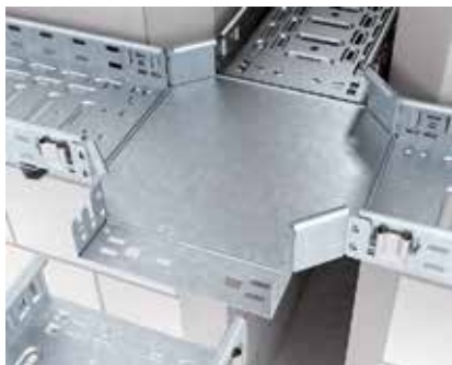
Montage Kreuzung Magic Montage von Formteilen durch einfaches Ineinanderstecken. Dabei wird die Kabelrinne mit der Federseite von oben in den Formteilanschluss gerastet.
