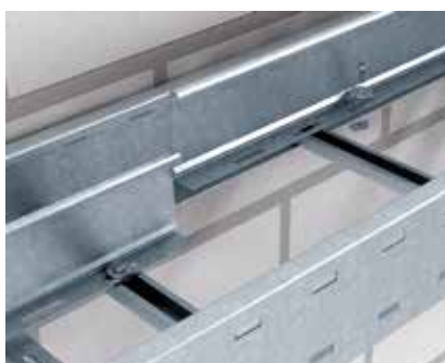
Geschraubte Trennstegbefestigung Trennstegmontage in Weitspannkabelleitern. Die Befestigung erfolgt mit Gleitmuttern und Sechskantschrauben.
