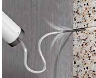
Reinigung der Bohrung Ausblasen der Bohrung zur Reinigung mit Handausbläser oder Druckluft.
