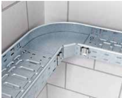
Montage Bogen Magic Montage von Formteilen durch einfaches Ineinanderstecken. Dabei wird die Kabelrinne mit der Federseite von oben in den Formteilanschluss gerastet.
