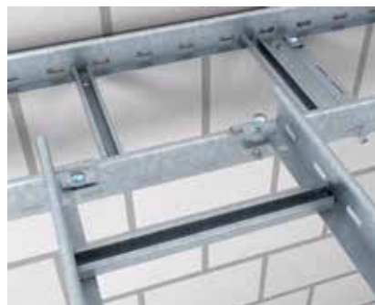
Montage T-Abgang Herstellen eines horizontalen T-Abgangs bei zwei auf unterschiedlichen Höhen verlaufenden Kabelleitern. Zur Fixierung der Kabelleitern miteinander wird der Auflegewinkel Typ LAW benötigt.
