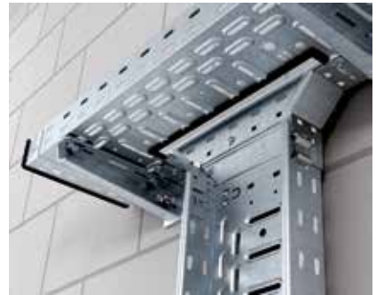
Montage Anbau-Abzweigstück Magic vertikal (Ansicht unten) Vertikaler Einbau des Anbau-Abzweigstücks als Abgangstrichter längs. Lochung in der Kabelrinne wird bauseits erstellt. Für Breiten > 400 mm Verbindermaterial separat bestellen!
