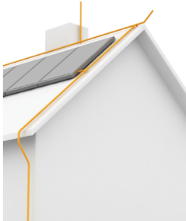
Direkter Anschluss der PV-Montagegestelle an das Blitzschutzsystem
