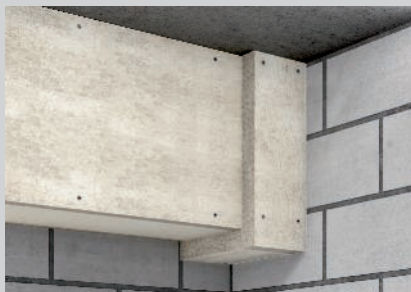
Wandanschluss mit Wandanschlusskragen
