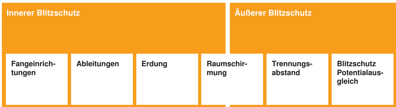
Systeme des äußeren und inneren Blitzschutzes
